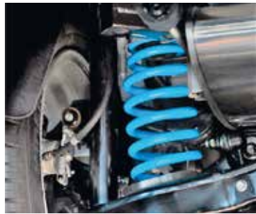
HV-.....1 : Reemplazan los muelles principales de origen y aumentan el juego completo de muelles delantero y trasero
