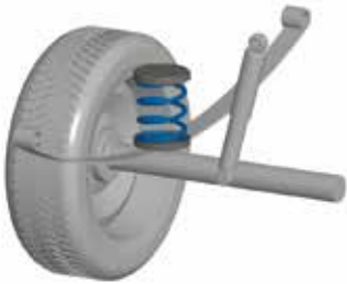
HV-.....0 : Instalado al lado del muelle de origen
